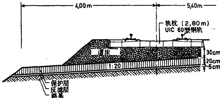
图 1—2 高速铁路有碴轨道断面
