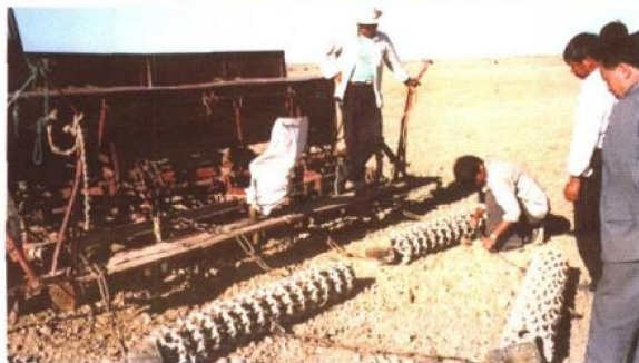
彩图1-10 采用24行大型播种 机。该播种机仅限66.7公顷 以上大块土地时使用，该机 型工作效率高，每天可播6.7 公顷以上，但播种粗糙，易出 现缺苗断垄现象
