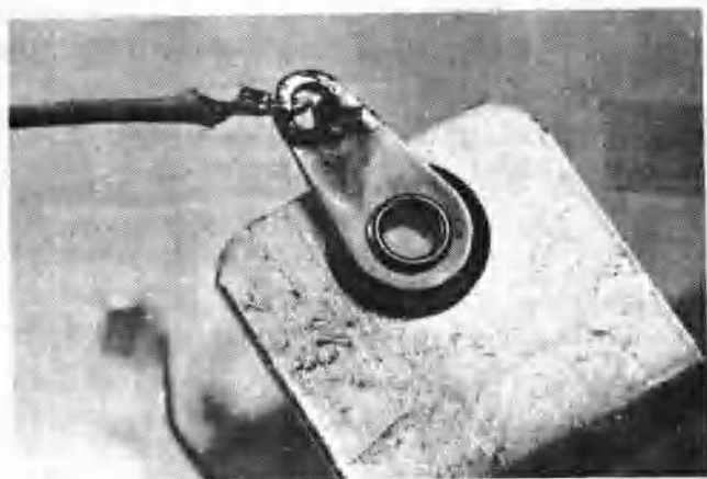
圖 1-5 銲接不良的接點
