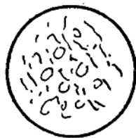
图16 拉风坐料，矿焦紛紛落下，并夾有渣水下滴，爐溫很低。
