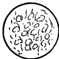
图14 爐子进冷风，矿石焦炭紛紛下落。
