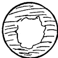
图9 渣比高，爐子凉风嘴前成一不规则边缘。
