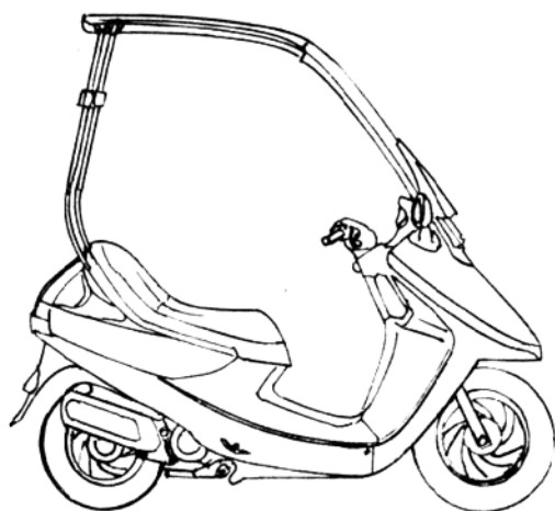
图 1-13 本田 Cabina90(50)型二轮坐式全天候摩托车
