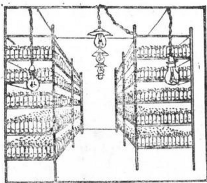
图 1—6 培养室(室内装加温红外灯泡、自动调温器及温度计等设备)
