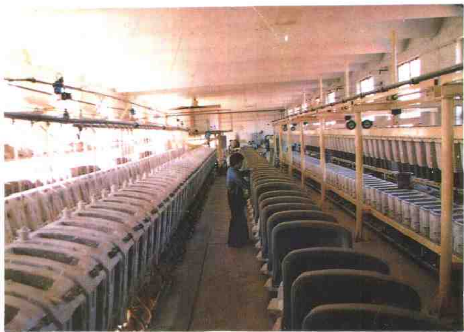
唐山陶瓷厂引进的卫生瓷立式浇注生产线
