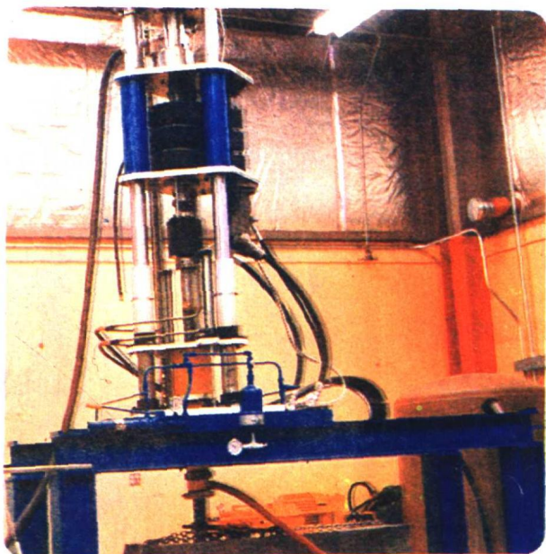
彩照 4 中美双方钻头对比台架测试用试验台架
