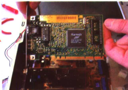
(3) 在主板上的任意插槽中插入并固定 PCI 网卡
