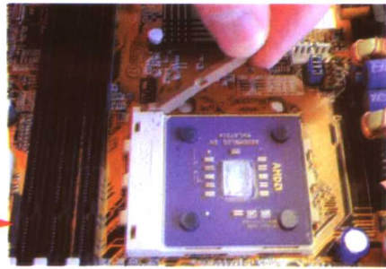
(2) 正确插入 CPU 并放下锁杆
