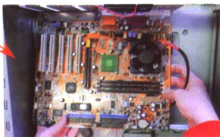
(2) 对准机箱预留孔将主板轻轻置入机箱
