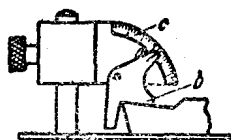
图 8 用台式量角器测量主前角
