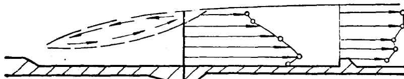
b) 闸孔中心剖面处流速分布
