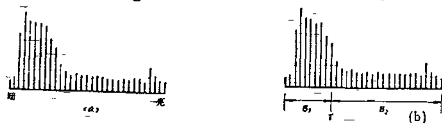
图 8-1-1 图象 f(x, y) 的直方图
