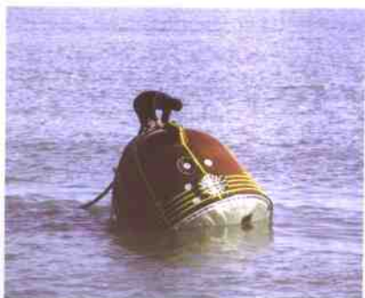
神舟号飞船返回舱进行水上漂浮试验。
