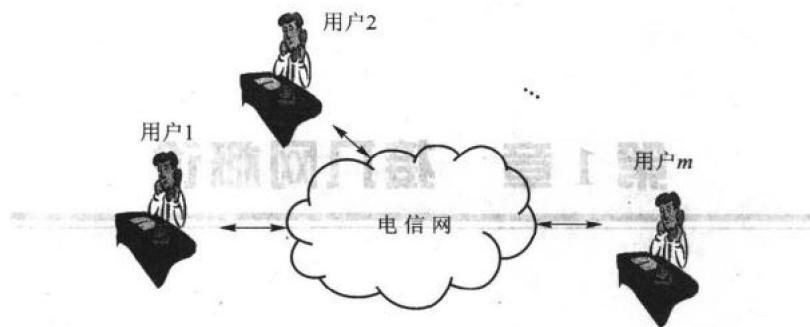
图 1.1.2 点到多点电信网结构模型
