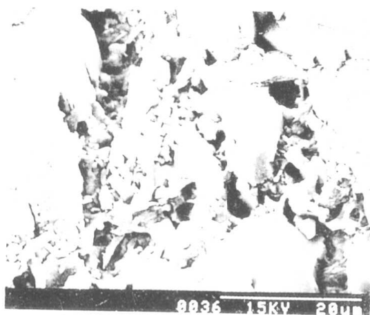
a 2 在 50℃、PH=13时,石英表面沿裂隙溶蚀形成溶蚀沟及碎裂微粒。
