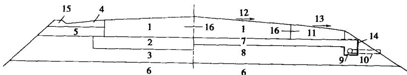
图 1-1 水泥混凝土路面结构
