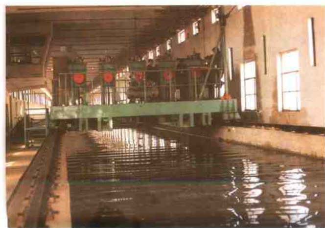
□黄委会水文局流速仪检定大厅 (任建华、方春燕摄)
