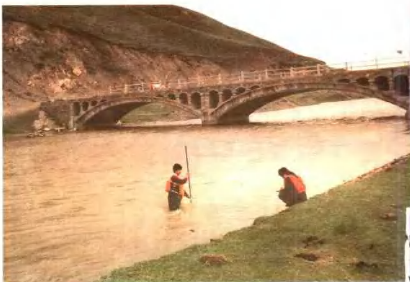
□黄河沿水文站职工涉水测流 (王清叶提供)
