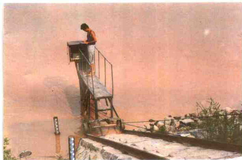
□利津水文站斜坡式自记水位计 (殷鹤仙摄)
