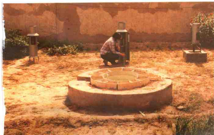
□白家川水文站职工观测蒸发 (黄河博物馆提供)
