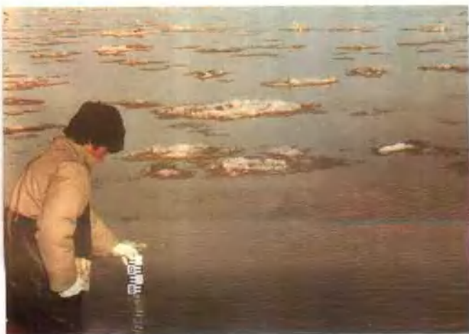
□头道拐水文站职工冰期观测水位 (王清叶提供)
