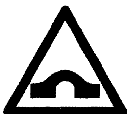
驼峰桥标志 表示前方通过桥梁， 视线不良，注意安全
