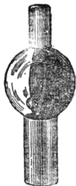
圖 1. 最新式光電管的外形
