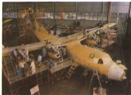
圖A-15 一架新飛機的最後組合，太空工程師負責飛機、太空船的設計與發展。
