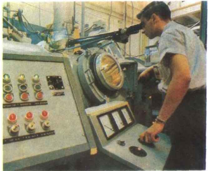
圖 A-10 這技術員正在調整電子放射線焊接機以引導一連串之測試。
