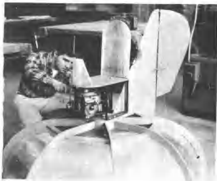
圖 1-10 一個學生設計並製作他的作業。現在他正安裝帶動螺旋槳的起動引擎。經檢試之後，這個實驗性質的作業即可完成而交由老師評鑑。必要時學生可以再繼續改進，以增進其效能。
