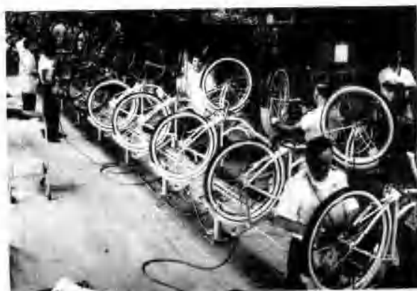
圖 1-12 腳踏車大量生產工廠最後裝配線上的裝配情形。
