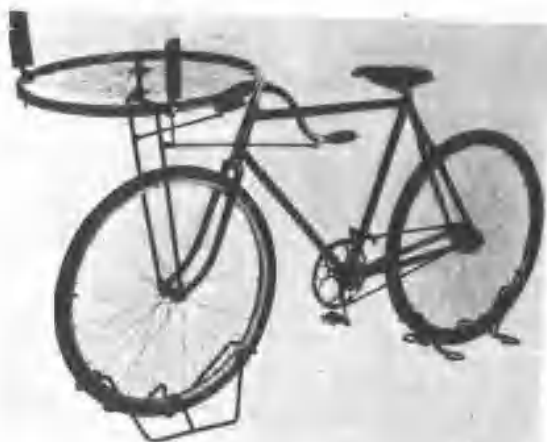
圖 1-21 這是懷特兄弟在設計和發展他們的飛機時，用來做空氣壓力試驗的腳踏車。這是我們所謂研究發展的一個例子，那個時候幾乎沒有工程方面的書籍供他們來研究，因此只有不斷地實驗和嘗試錯誤來完成他們希望完成的工作。
