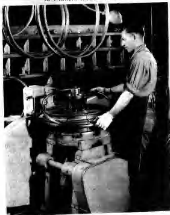
圖 1-13 每一部腳踏車都有兩個輪子，這是腳踏車輪的自動成形機器。
