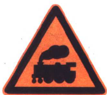
警 34 无人看守 铁路道口
