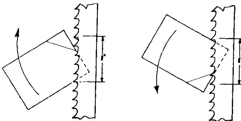
為了實際的目標（生產率，低工具成本和操作員的疲勞）最大的工件厚度為 1 吋。然而如果這些因素可以作部分犧牲的話，大於 1 吋厚的工件可以用搖擺的技巧來造成較小的接觸面，而使其易於產生高溫以利切割。
