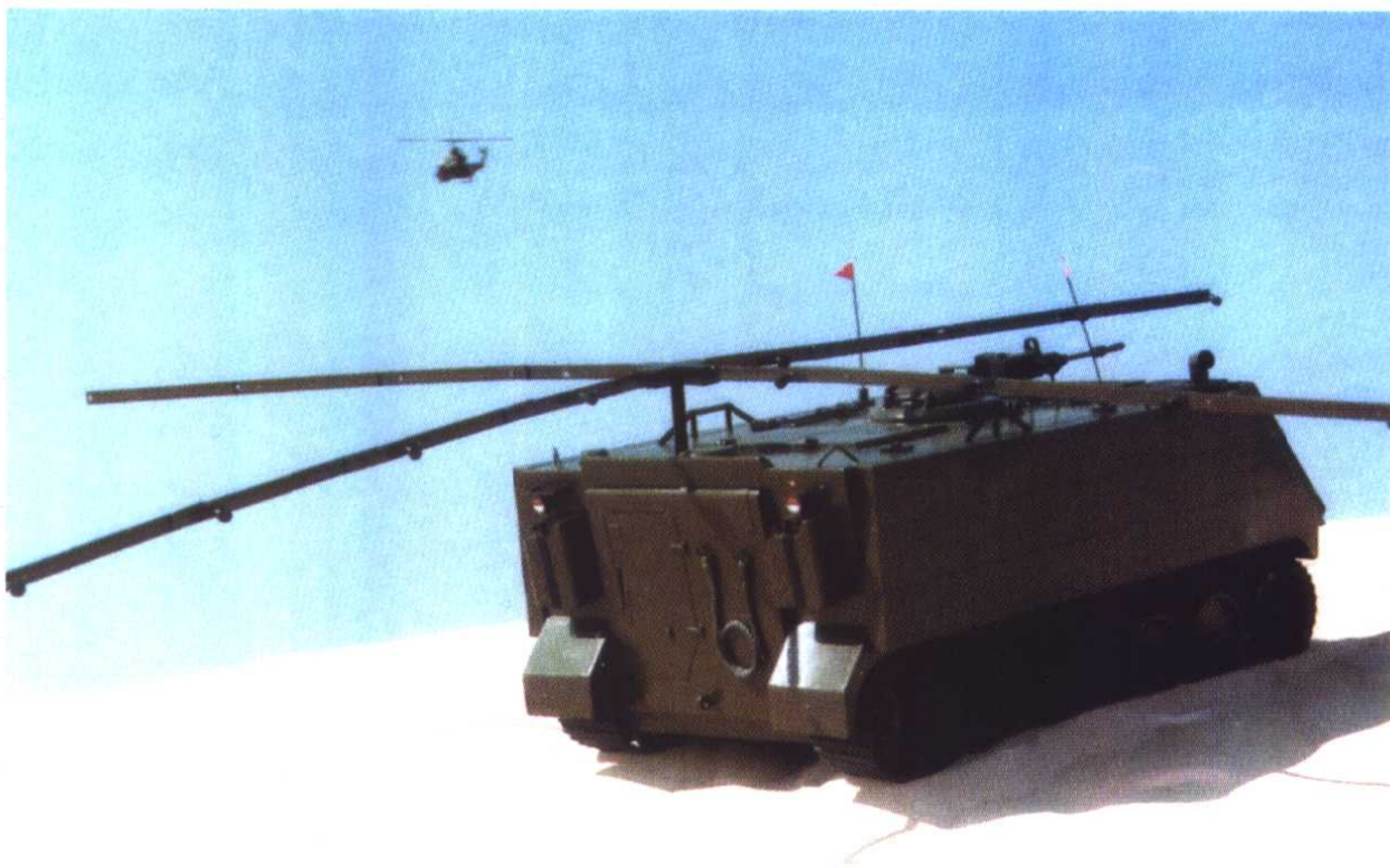
作用距离: 10~12 km 频带: 5~150 Hz 传感器: 16个 以色列 RAFAEL 公司研制的直升机探测系统 HELISPOT
