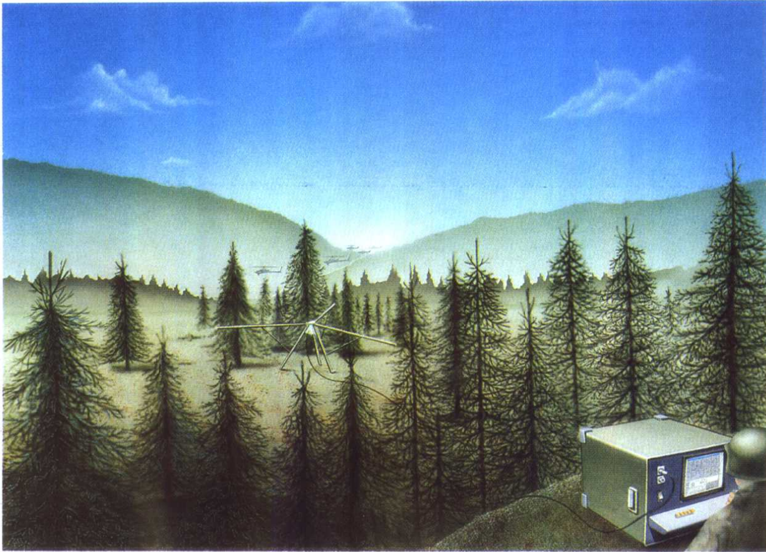
星形 3m长天线阵 信号传输线: 100m光纤 作用距离 15km 芬兰 Partria 公司研制的被动直升机预警系统 PHD
