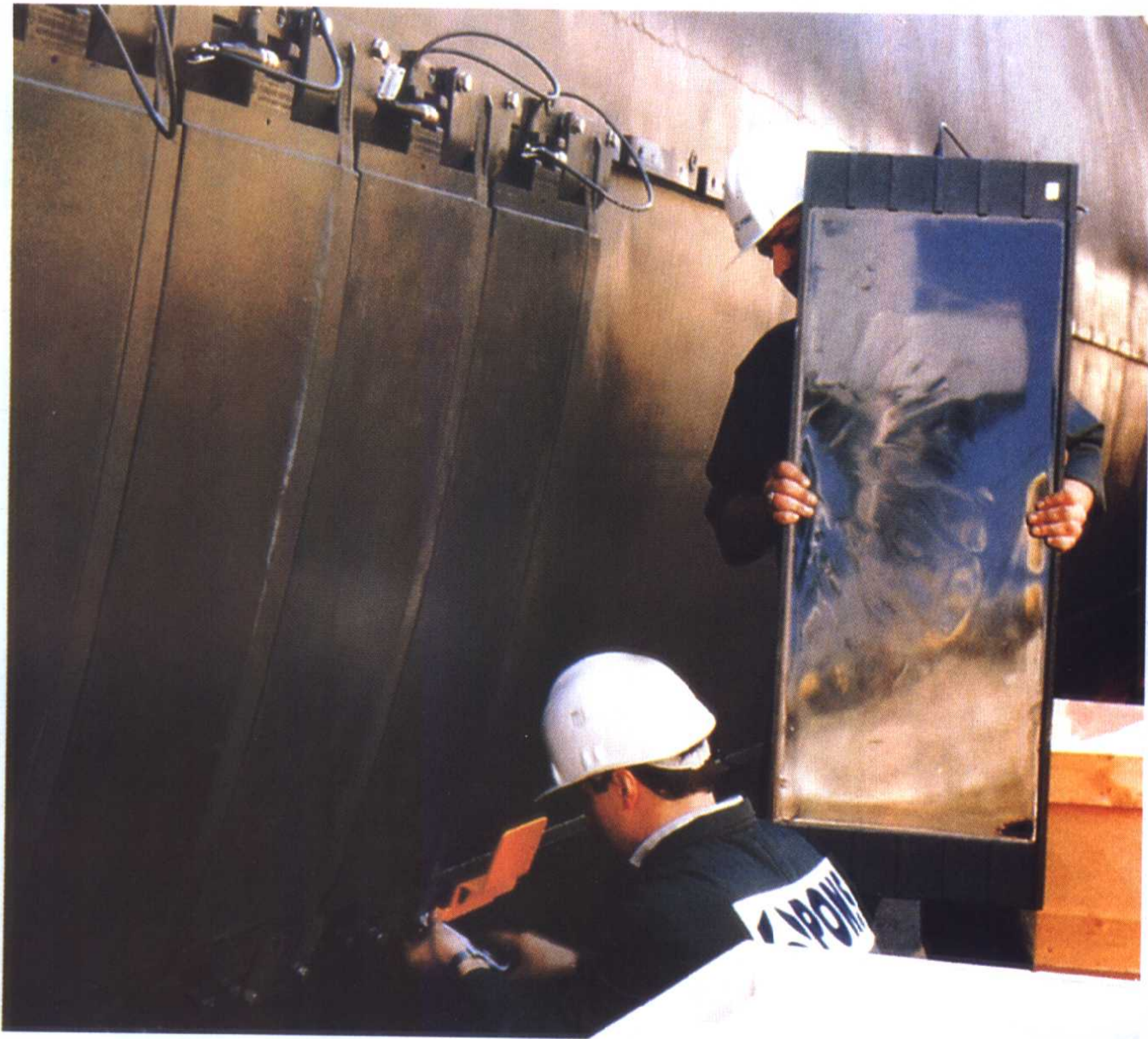
英国和法国联合的 Thomson-Marconi 公司研制的舷侧线列阵声纳 TSM2253 这是一种利用 PVDF 材料作为换能元器件的舷侧线列阵声纳，是一种平面基阵。 相关内容见本书第 8 章。
