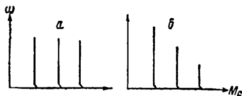
图1 钻机回转器(a)和卷扬机(б)的机械特性曲线
