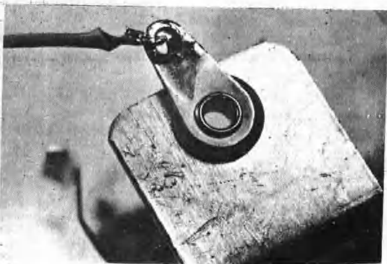
圖 1-6 銲接不良的接點
