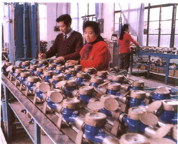
▲福州水表厂生产的“中福”牌水表评为国家机械工业部和福建省名牌产品,图为工人在检测水表质量。
