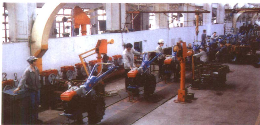
◀福建拖拉机厂手扶拖拉机装配流水线。
