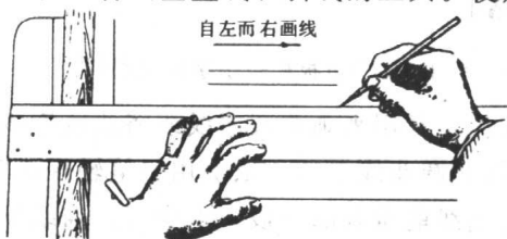
图 1-1 用丁字尺画水平线
