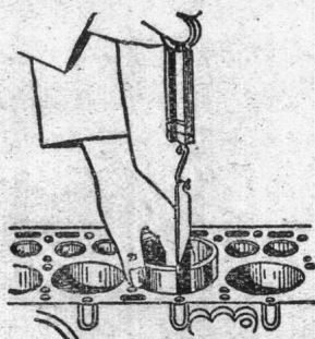
用厚薄规测量活塞裙部与气缸壁的间隙
