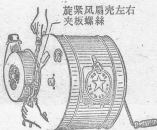
圖7 旋緊風扇壳左右夾板螺絲
