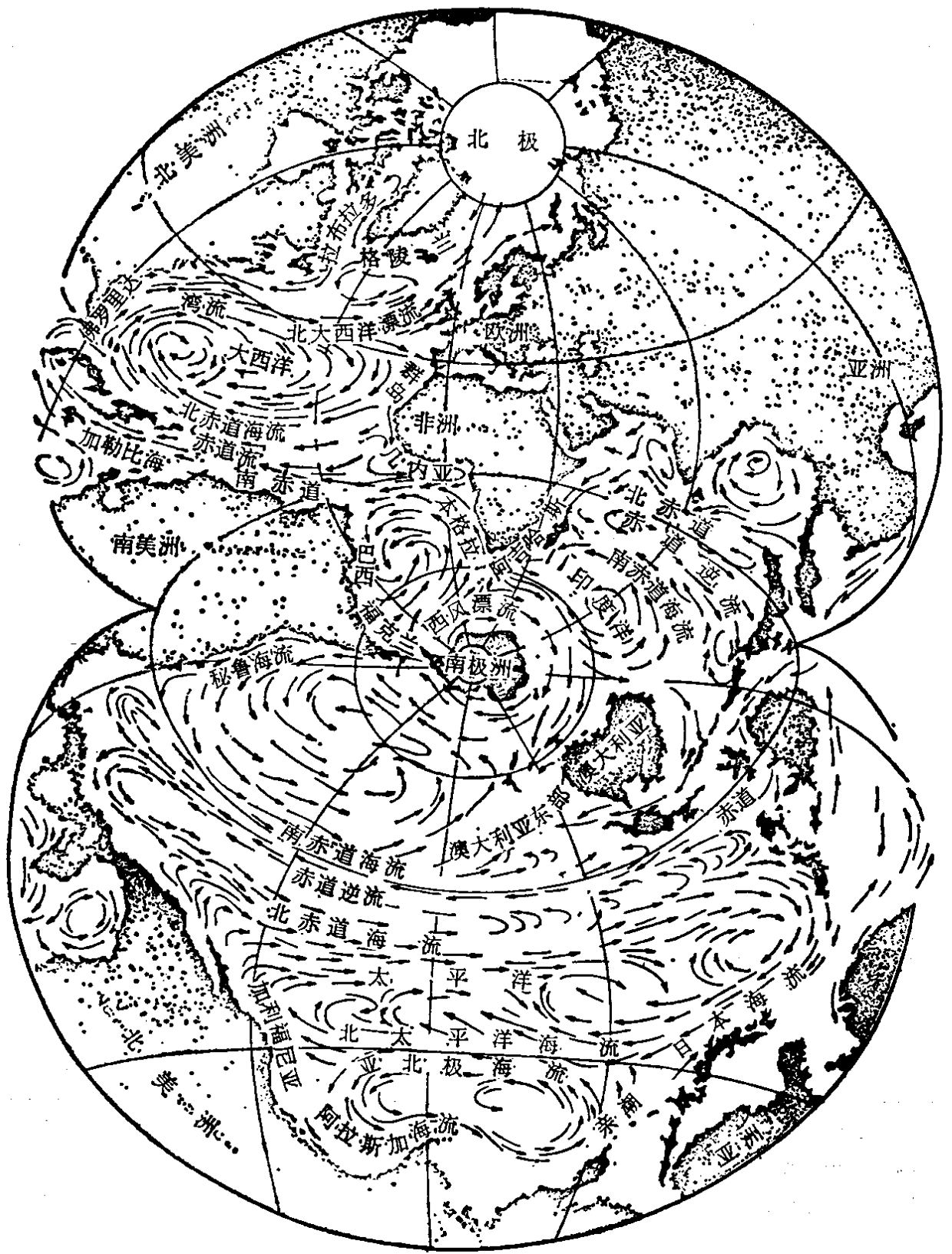
图 20-6 大洋的表面海流。环流的分布（北半球顺时针方向，南半球逆时针方向）可解释为全球风向分布的结果——北纬40°和南纬40°左右的主导西风自西向东吹，紧靠赤道南北的信风自东向西吹 〔12〕
