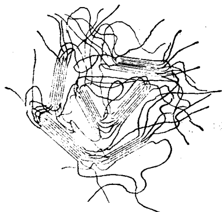
图 1-3 高聚物的晶区与非晶区示意图
