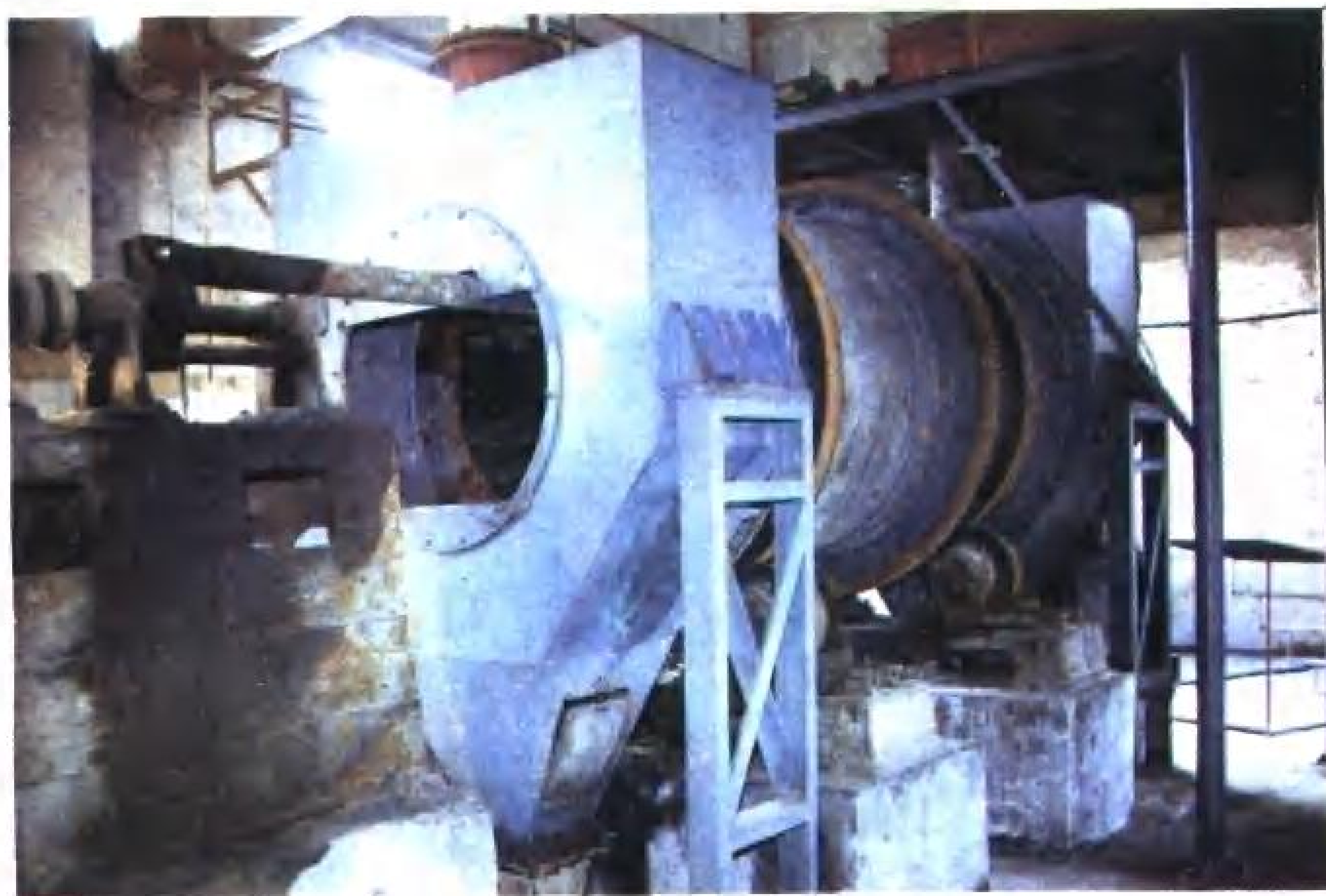
县复肥厂具有现代先进水平的巨型转鼓造粒设备
