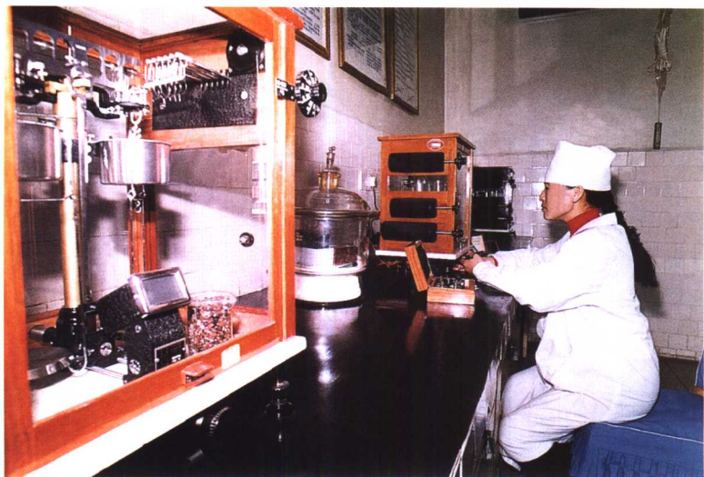
(24) 玉门石油管理局第三计量室的检验人员在用精密天平进行计量检定。
