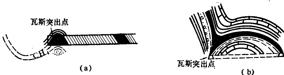
图 1-1 地质构造带内瓦斯突出点位置示意图
