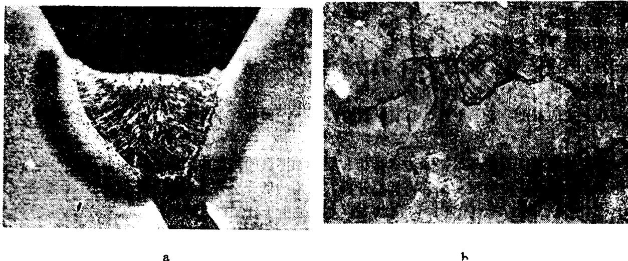
图 1-4 焊接接头再热裂纹
