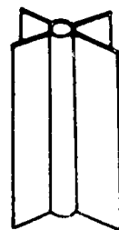
图 1—11 5Z4P 电子管的屏极结构
