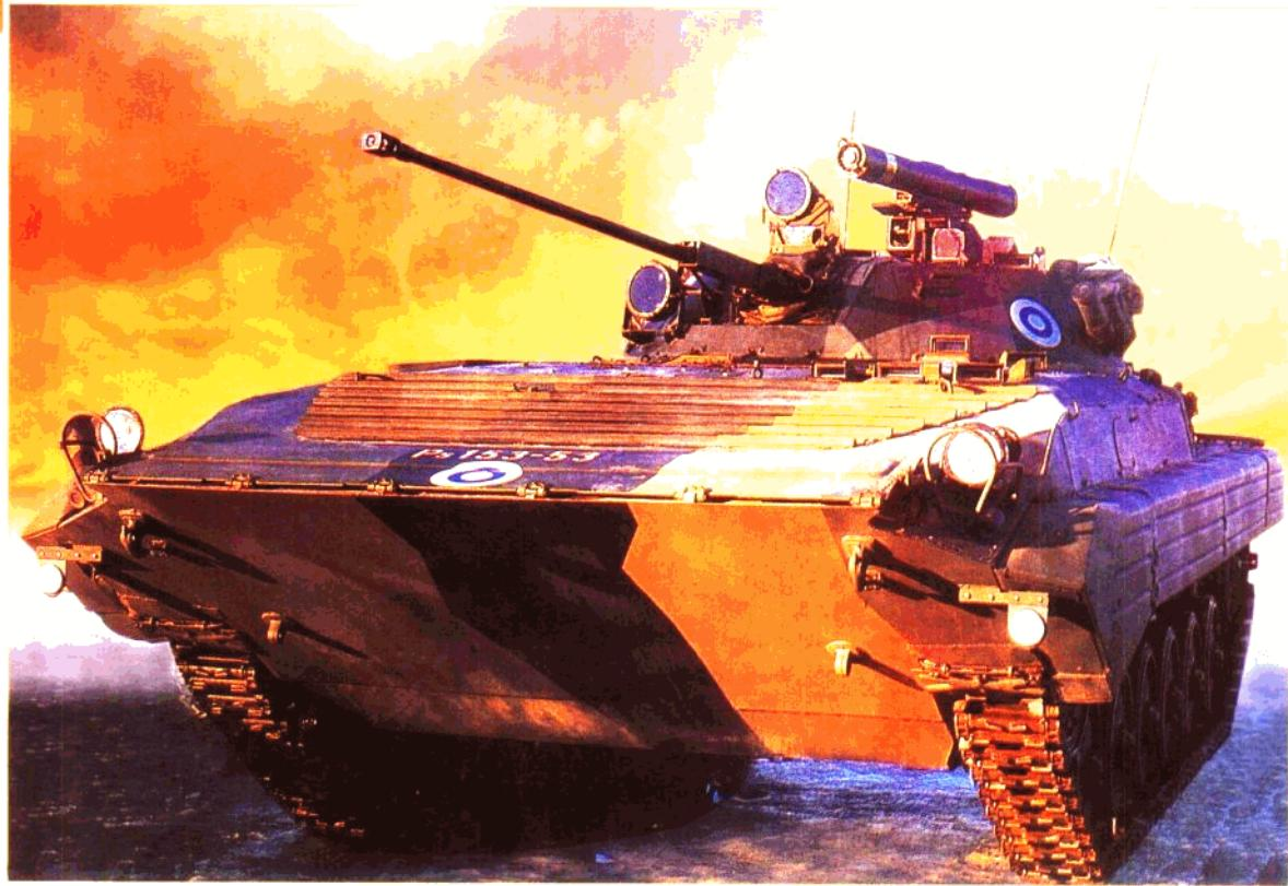
BMP-2步兵战车的战斗全重14.6吨，乘员3人，载员7人。这种战车采用双人炮塔，装备有30毫米机关炮、并列机枪和一个反坦克导弹发射筒。
