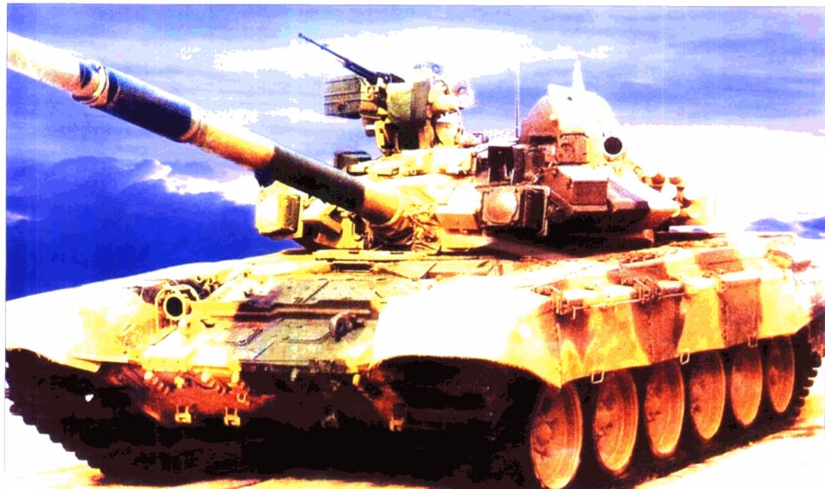
T-90坦克采用了T-72坦克的炮塔和T-80坦克的车体，吸收了这两种坦克的长处，所以有人戏称它是“混血儿”。这种坦克具有紧凑、可靠、廉价的特点。它的主要武器是一门125毫米的滑膛炮，配有四枚炮射导弹，既能打坦克，又能打直升飞机。炮弹的命中率高，在5000米远的射程上，命中率可达70%以上。它自身装有反应装甲和辅助防御系统，是目前世界上防护性能最好的坦克之一。
