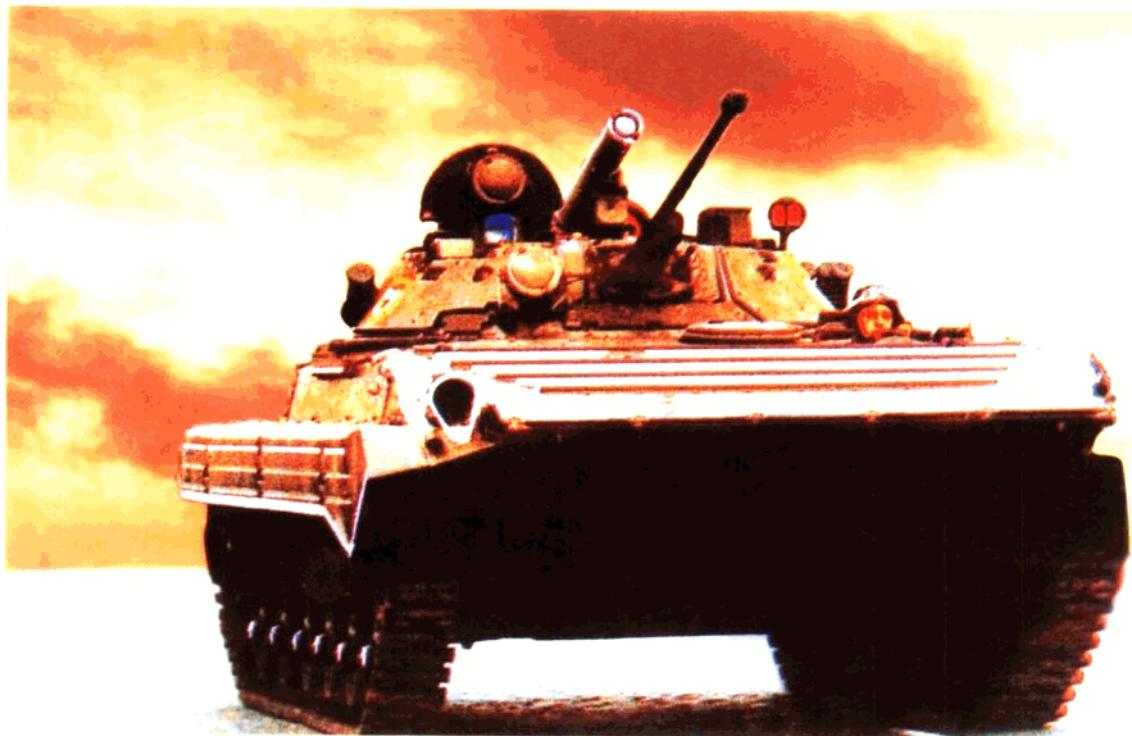
BMII - 3步兵战车的炮塔上装有能发射导弹的100毫米火炮，另有一门30毫米机关炮和一挺并列机枪，这三种武器的轴线相互平行，共用一套火控系统，可以随炮塔旋转360度。另外，在战车车体的前方两侧各装有一挺机枪。它的装备武器最多，火炮口径最大，被称为是当今世界上火力最强大的步兵战车。
