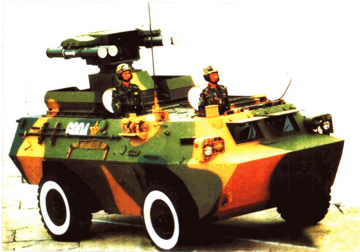
新式重型反坦克导弹配装在一辆四轮装甲车上。这种反坦克导弹具有很强的穿甲和破甲能力，是一种威力很大的反坦克武器。
