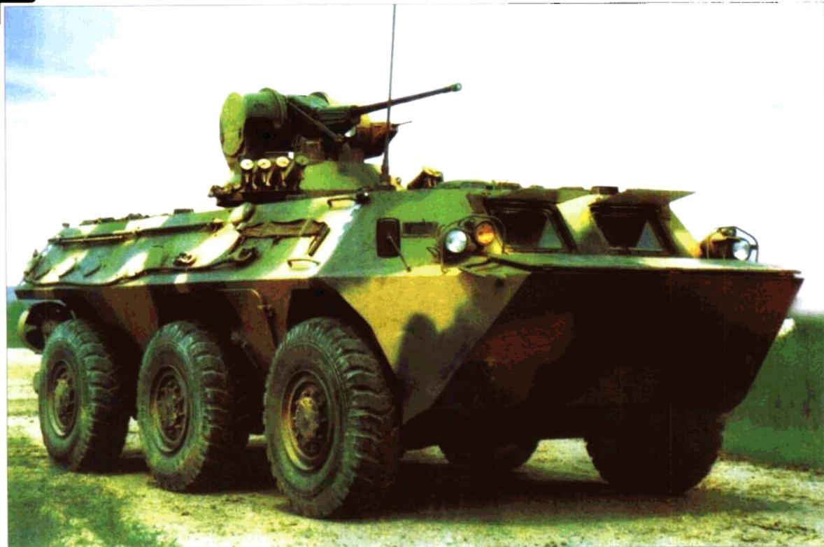
WZ551轮式步兵战车长6.6米，宽2.8米，高2米，是一种 $6 \times 6$ 全轮驱动、等轴距的高越野性车辆。车顶装有一挺25毫米机枪，另外左侧还有一挺7.62毫米的并列机枪。这种战车具有水上行动能力，可以自行浮渡。
