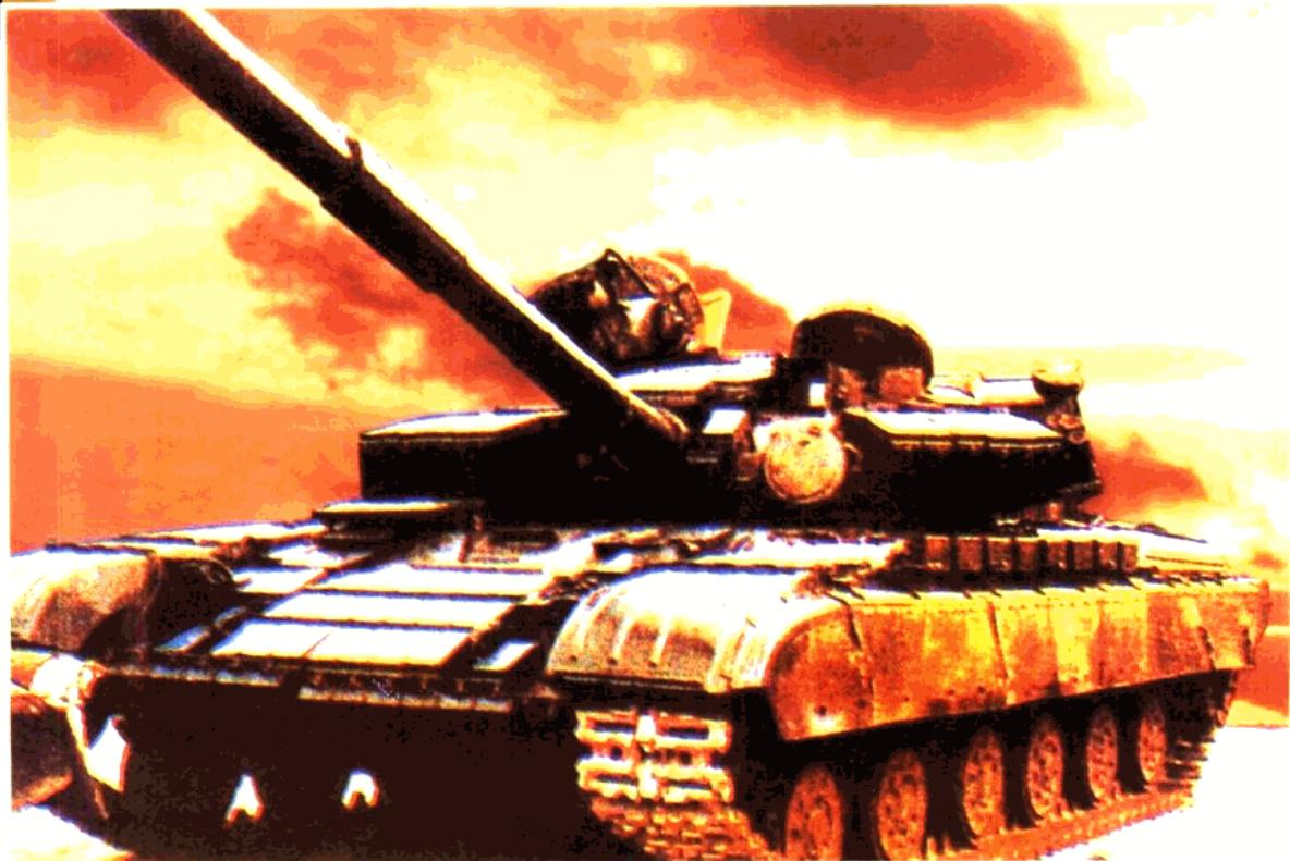
T - 64 坦克，车体长7.45米，宽4.64米，高2.2米，战斗全重42吨，公路行驶速度可达每小时75千米。它的装甲厚度达200毫米，防弹构形很好，具有很强的防护能力；它的火力强大，能发射反坦克制导炮弹。
