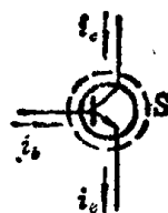
图 1-13 电路封闭面举例
