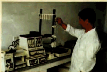
广东省农业科学院兽医研究所的科技人员正在使用 Econo 低压层析系统进行研究。该系统主要应用于蛋白质和核酸的分离纯化，是一部较先进的智能型的实验仪器。
