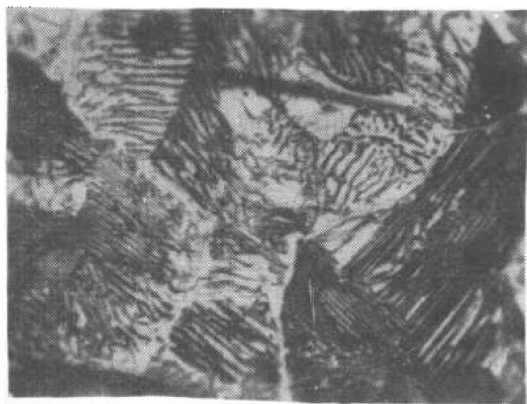
图 2-1 共析碳钢片状珠光体 600\times (930 ^{\circ}\text{C} 炉冷)
