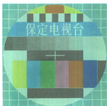
图11 标准测试图偏绿色
