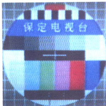
图 29 标准测试图网纹干扰
