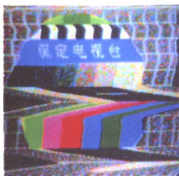
图 24(d) 标准测试图扭曲
