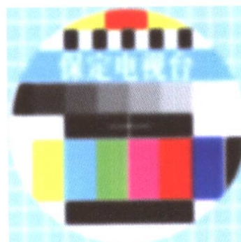
图20(b) 标准测试图模糊
