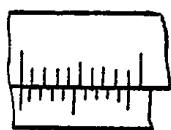
图 1-11 游标读数值0.1毫米游标卡尺的刻线原理
