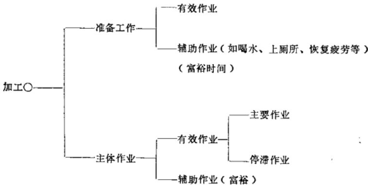
加工同一种产品,准备工作只做一次,但主体作业每个零件都要重复做一次。如车工工序,只是在开始切削时才算主体作业。仔细分析,加工工序中也只有主体作业才创造价值(因为它通过切削改变了零件的形状)。所以改善主体作业是提高生产率的关键,也是生产管理的主要目的。一切不创造价值的无用动作要尽量减少或排除。
