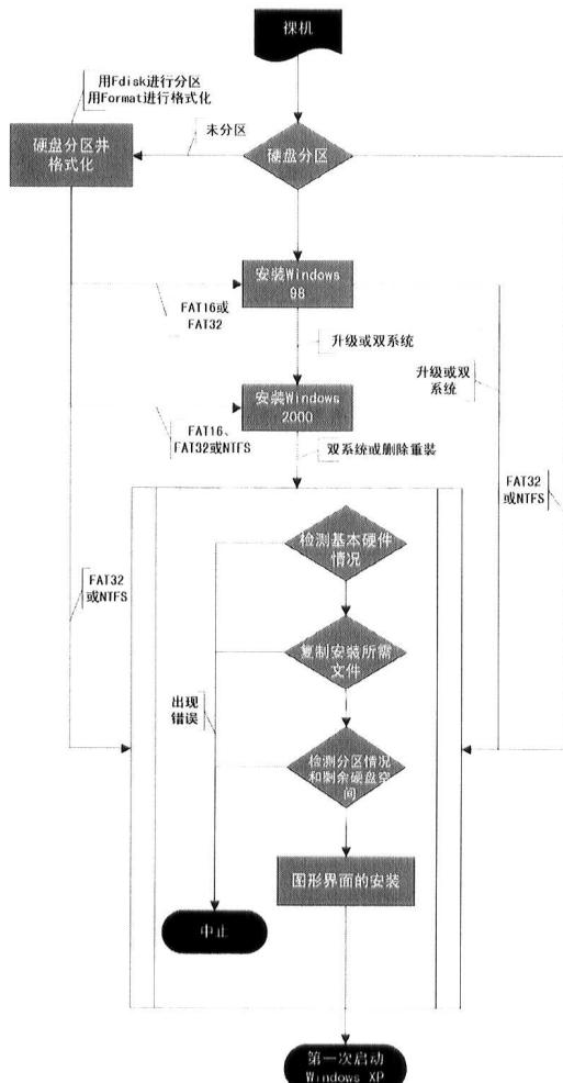
Windows XP的安装方式很灵活，如果在电脑上已经安装了Windows 9X，就可以选择升级安装或全新安装，两者的区别是：升级安装会将Windows XP安装在Windows 9X的同一个分区中，在Windows 9X中已有的大部分程序、数据文件和设置都不需要重新安装，但以前的Windows 9X将不能再使用了。全新安装需要另一个硬盘分区，即Windows XP应安装在Windows 9X所在分区之外的另一个分区中（如果安装在同一分区，Windows 9X将不能使用，并且会带来诸多不便），Windows XP将自动生成多系统启动菜单并完整保留原有系统，但在Windows 9X中安装的许多应用程序在Windows XP中将不能使用，要重新安装。
