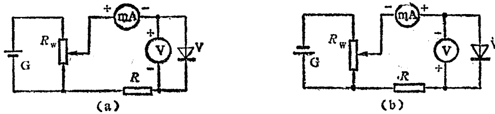
图 1-8 测量二极管伏安特性 (a) 正向特性 (b) 反向特性
