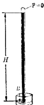
图 1-2 用水银气压计测量大气压力示意图
