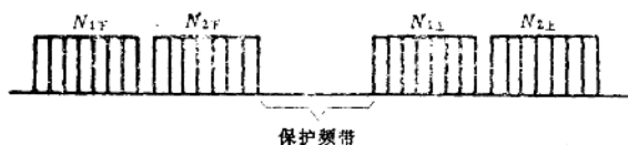
图1-6 有中心交换台兼直通的频分窄带选址通信的频率分配方式
