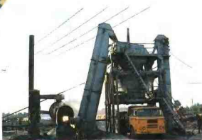
自动控制沥青混凝土拌合机
