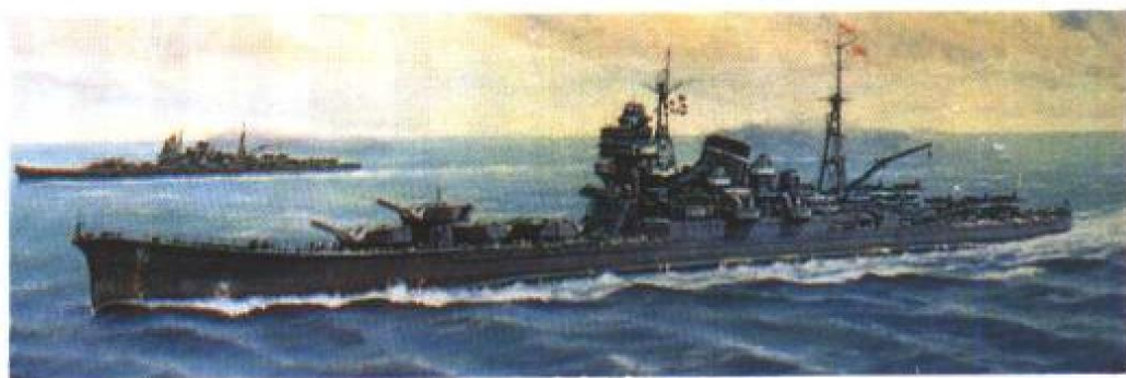
图 30 日本重巡洋舰“筑摩”号的 203 毫米主炮集中在前部，空出后部甲板搭载 5 架水上飞机以增强侦察能力。
